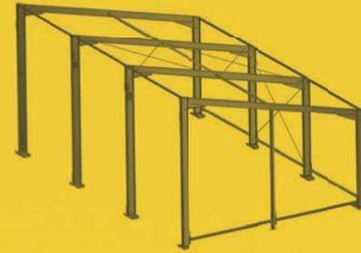
Die Konstruktion der Pultdachhallen wird mit Doppel-T-Trägern ausgeführt, kann nach Kundenwunsch den individuellen Anforderungen angepasst werden und bringt somit individuelle Flexibilität.
