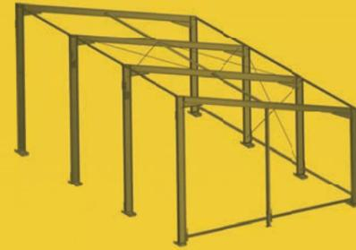
La construction des halls en appentis est réalisée avec des poutres IPE, qui peuvent être adaptées aux besoins individuels du client et offrent ainsi une flexibilité individuelle.
