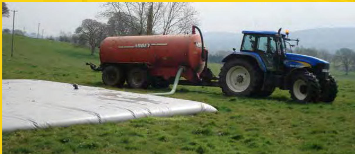
Serbatoio per lo stoccaggio di liquame
