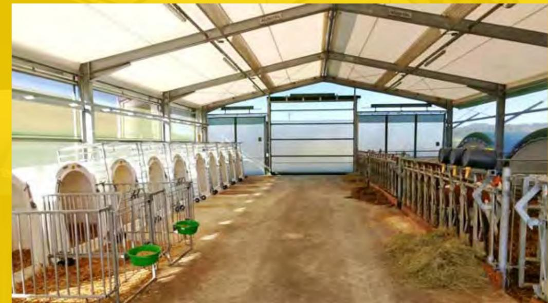
Steuerung der Belüftung durch seitliche Curtains und textile Tore
