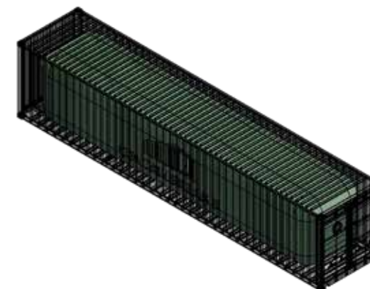
Gassack in einem Container
